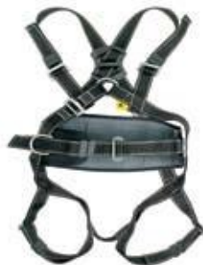
P56 Four Point Body Harness cu 2 puncte de ancorare frontale si 2 dorsale, cu centura de pozitionare aditionala. Conformata cu EN 361 & 358.
