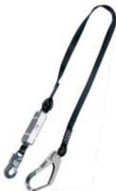
ABM-TA c/w Snap Hook ABM-TB c/w Scaffold Hook Coarda de lungime 2m cu absorbitor de energie si carabina cu autoinchidere sau infiletare. Conformata cu EN 355.
